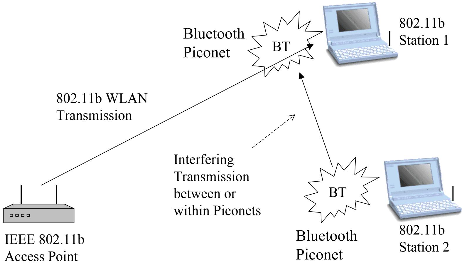
**Channel Model:**  $Channel(dB) = PL(d) + X_{\sigma} + Y$
